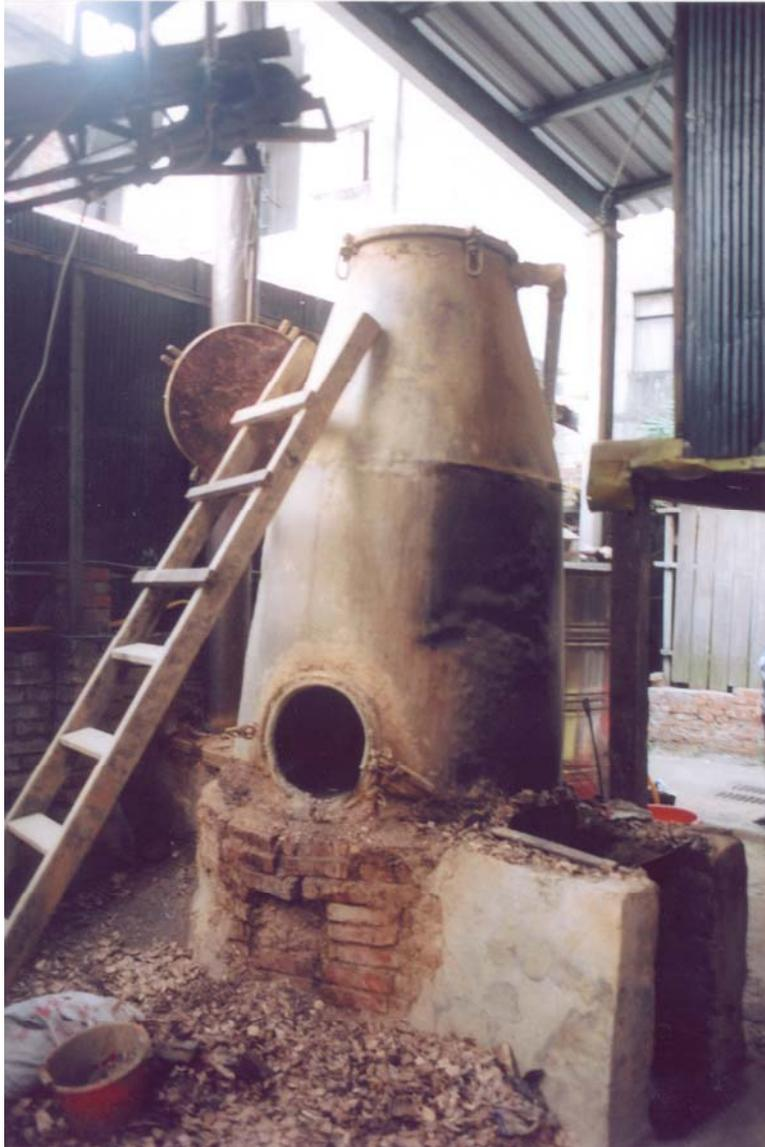
圖六 現在的腦灶、腦鍋與炊桶，與圖六十分類似，不同之處大約只有炊桶、蒸氣管線、冷卻器、腦田由木製改變成金屬製，進料由上方的輸送帶送入，樓梯是讓人上到炊桶中踩實桶中樟樹匕。本腦灶位於新竹縣峨眉鄉。
