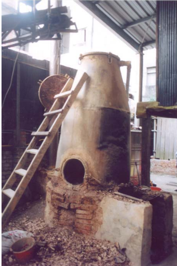
圖七 現在的腦灶、腦鍋與炊桶，與圖六十分類似，不同之處大約只有炊桶、蒸氣管線、冷卻器、腦田由木製改變成金屬製，進料由上方的輸送帶送入，樓梯是讓人上到炊桶中踩實桶中樟樹匕。本腦灶位於新竹縣峨眉鄉。
