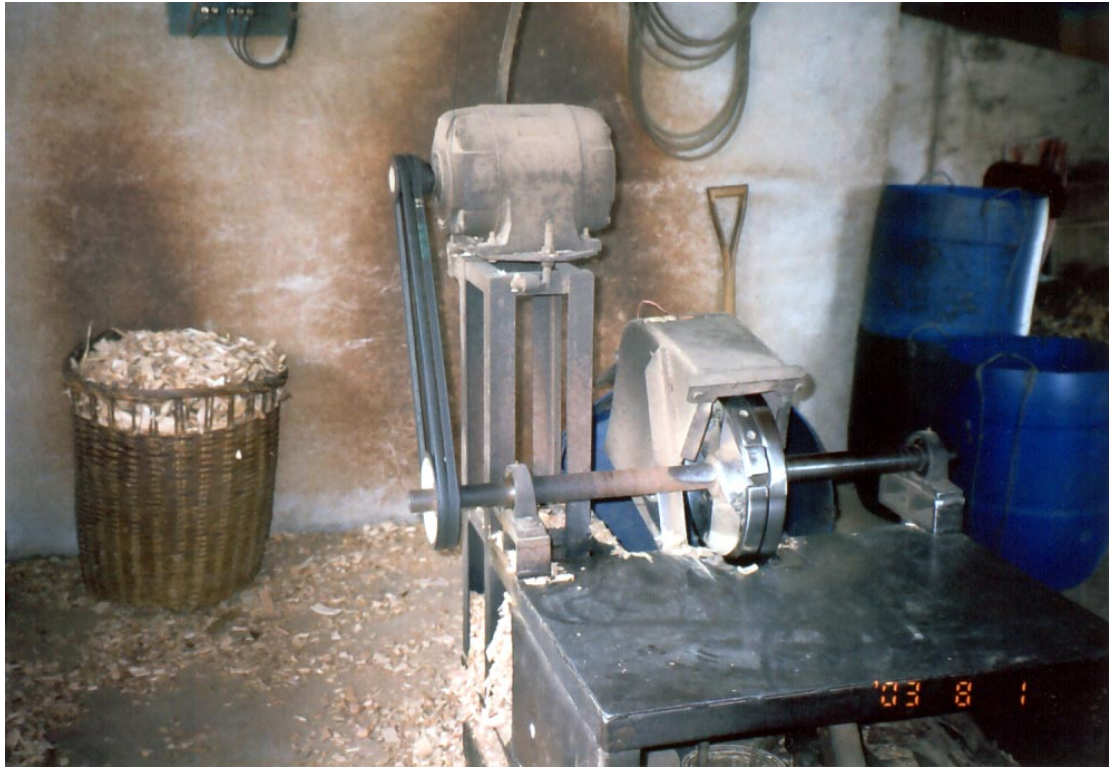
圖十一 樟樹削片機，好像手斧掛在圓形轉輪上，由動力馬達帶動轉輪，將樟樹切成碎片，送入炊桶中焗腦。此機器切出的木片比手斧鋒子剷出木匕要厚得多，不太像是木匕而類似小木塊，但是木塊中有許多裂痕，也可以將樟腦蒸餾出來。
