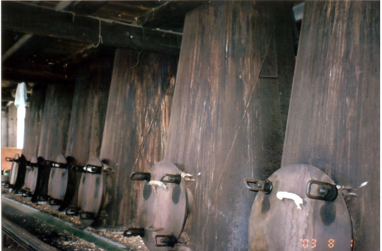
圖八 一個鍋爐管六個炊桶的新式焗腦鍋爐設備，即一鍋六桶。進料口在炊桶上之平台，出料口下接一個運料輸送帶，將蒸過的樹乚運至鍋爐邊當燃料。本設備在苗栗縣銅鑼鄉樟樹村。
