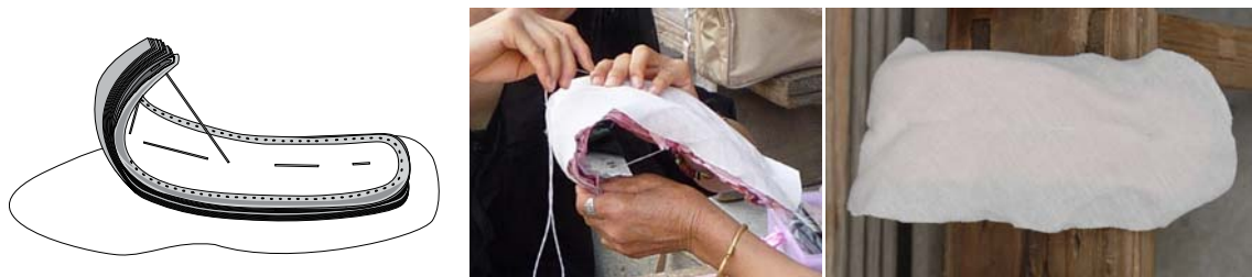
圖 89：以針線綴縫固定鞋底的每一層布料，在鞋底中央部位綴縫
