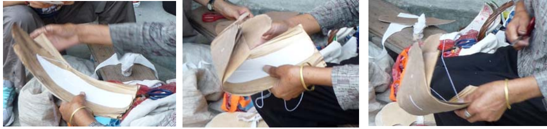
圖 78：再套上 3 層竹籐以針線疏縫，縫至鞋尖時向下拉拗使前頭彎翹呈船形
