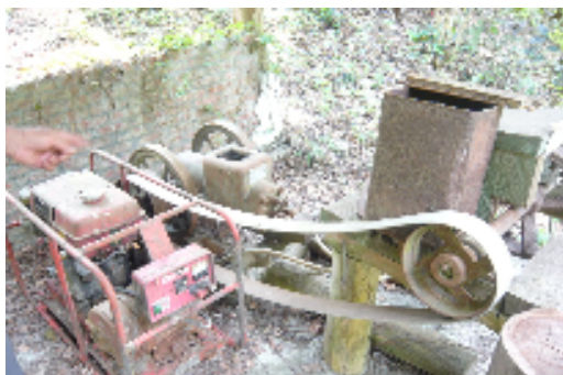
圖 2-25：日治末期削樟樹皮已經用引擎代替人力了。
