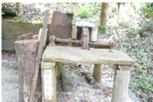
圖 2-27：削樹皮的切片工作檯與刨刀機。
