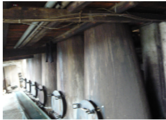
圖 2-12：把蒸氣由導管引入「腦槽」冷卻。
