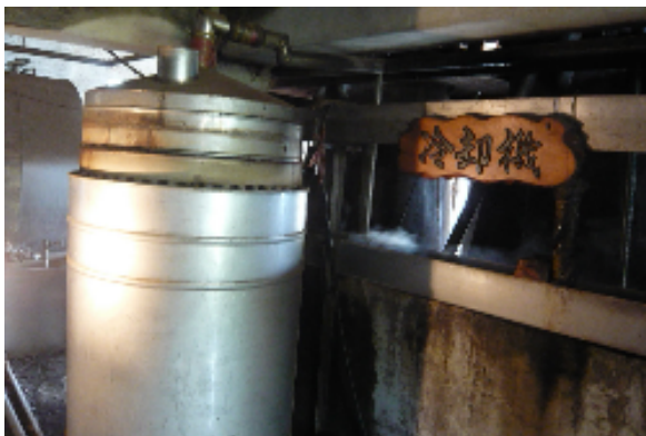
圖 2-13：接著導入冷卻機凝結成油水。
