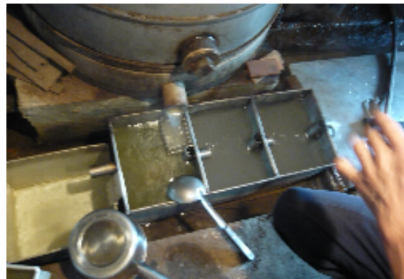
圖 2-14：讓樟腦油與水一起流出來，再利用油浮在水面的原理，將油、水分離。
