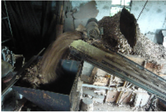
圖 2-9：轉盤木片緩緩而上倒入鍋爐口
