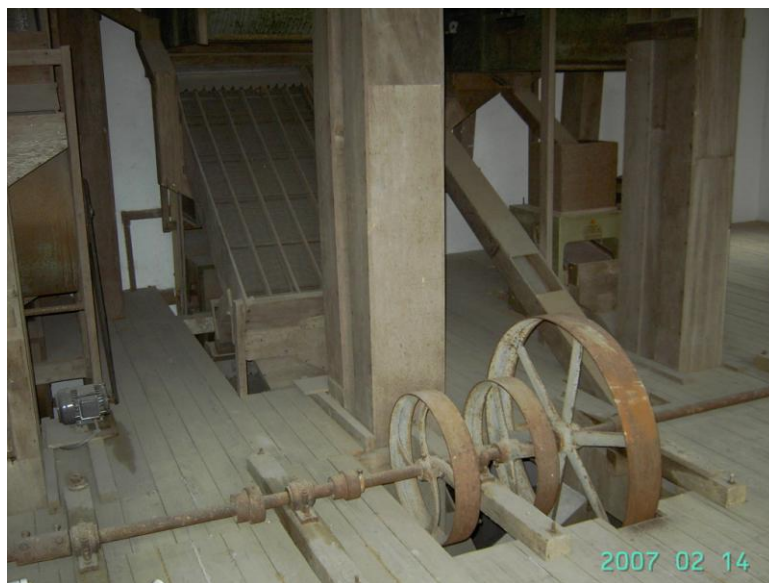
圖 3-4 日治時期保存至今的大型碾米機之部分結構。
