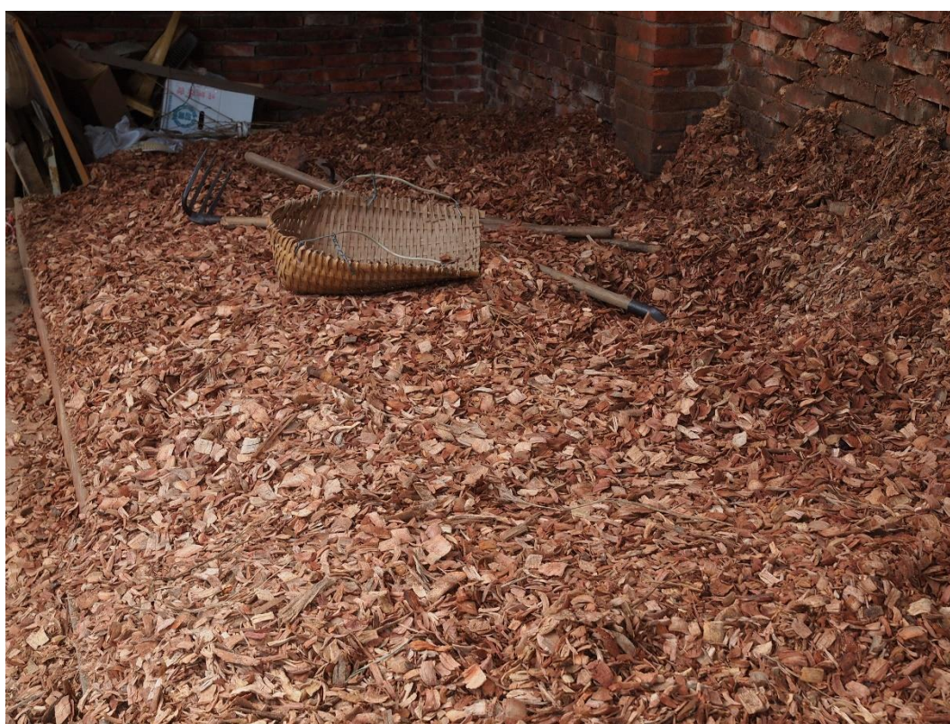
以機器刨製成碎片狀的樟木，供放入鍋爐內提煉樟腦。
